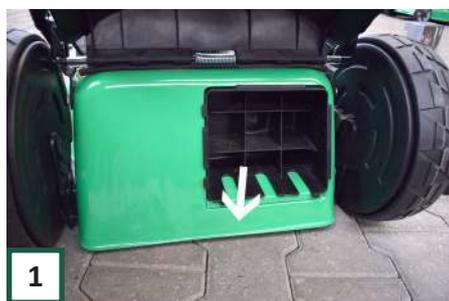
1 Wenn Sie den Fangkorb oder die hintere Entladung verwenden möchten, stellen Sie sicher, dass der Mulchstopfen entfernt ist.
