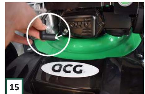
**15** Setzen Sie dann das Zündkerzenkabel wieder auf die Zündkerze. Die Montage der Maschine ist nun abgeschlossen.
