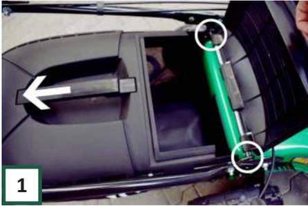
Heben Sie die hintere Klappe an, die den Korb bedeckt, und entfernen Sie den Fangkorb.
