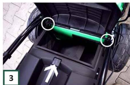
3 Platzieren Sie dann den Fänger oder die hintere Entladung, indem Sie die hintere Klappe hochziehen und das Teil am Rahmen einhaken.
