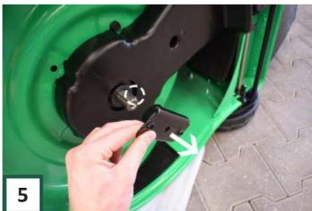
Befolgen Sie die Schritte 1 bis 4 auf Seite 19. Entfernen Sie dann die T-Kupplung von der Welle. Achten Sie darauf, den „Halbmondschlüssel“ in der Motorwelle nicht zu verlieren.
