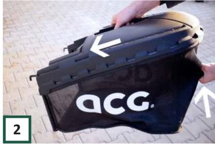
Der Fangkorb hat also eine Halterung und einen praktischen Griff auf der Rückseite. Sie können den Korb leicht kippen, um das gesammelte Gras zu entfernen. Dann ersetzen Sie den Korb.
