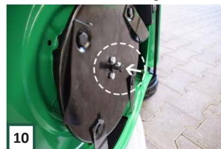
Schrauben Sie dann die Schraube mit der kleinen Unterlegscheibe durch das Messer in der Kupplung. Ziehen Sie es gut an. Das Messer ist jetzt angebracht. Stellen Sie die Maschine aufrecht und installieren Sie das Zündkerzenkabel (siehe Schritt 8 oben). Sie können jetzt mähen.
