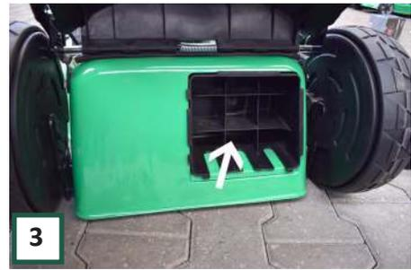
3 Setzen Sie nun den Mulchstopfen in das Loch für die hintere Entladung. Legen Sie den Korb nicht zurück, da die hintere Klappe den Mulchstopfen an Ort und Stelle hält.
