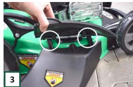
3 Platzieren Sie dann den Aufsatz für den seitlichen Auswurf, indem Sie ihn unter das Scharnier der Schutzabdeckung einhängen. Der Seitenauswurf ist jetzt vorhanden.
