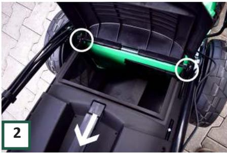
2 Entfernen Sie dann den Fangkorb oder die hintere Entladung, indem Sie die hintere Klappe hochziehen und das Teil entfernen.
