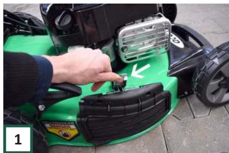
1 Wenn Sie die Seitenauswurf verwenden möchten, setzen Sie den Mulchstopfen ein und entfernen Sie den Korb. Ziehen Sie dann den seitlichen Auslassclip nach oben.
