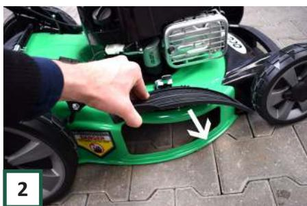
2 Stellen Sie sicher, dass der Seitenauswurf entfernt ist.
