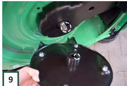
Nehmen Sie nun das Scheibenmesser und schieben Sie die Kupplung vorsichtig über die Welle. Setzen Sie dazu die Aussparung in die Kupplung für den Schlüssel ein. Das Ganze sollte leicht zusammenrutschen! Wenn es steif ist, versuchen Sie es erneut. Dies verhindert, dass das Messer schief montiert wird.
