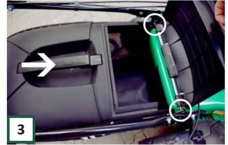
Stellen Sie sicher, dass beide Haken richtig an der Maschine anliegen. Dann die hintere Klappe wieder absenken. Sie können weiter mähen.
