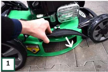
1 Wenn Sie die Mulchoption verwenden möchten, stellen Sie sicher, dass der Seitenauswurf entfernt ist.
