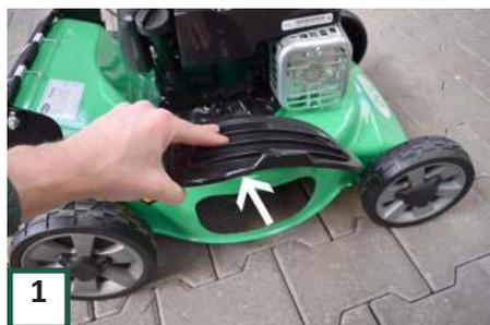
Wenn Sie die Mulchoption verwenden möchten, stellen Sie sicher, dass der Seitenauswurf entfernt ist.
