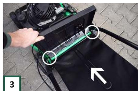
Platzieren Sie dann die Fangkorb, indem Sie die hintere Klappe hochziehen und die Korb am Rahmen einhaken.
