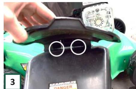
Platzieren Sie den Aufsatz für den seitlichen Auswurf, durch Sie ihn unter das Scharnier der Schutzabdeckung einhängen. Der Seitenauswurf ist jetzt vorhanden.
