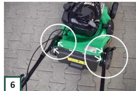
**6** Befestigen Sie den Lenker mit 4 Schlittenschrauben und Muttern an der Außenseite der Halter an der Maschine. Verwenden Sie den Schraubenschlüssel 13. Schrauben innen, Muttern außen.
