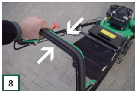
**8** Es ist auch möglich, die Selbstfahrfunktion durch Ziehen des hinteren Hebels zu aktivieren.
