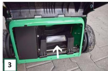
Setzen Sie nun den Mulchstopfen in das Loch für die hintere Entladung. Legen Sie den Beutel nicht zurück, Die hintere Klappe hält den Mulchstopfen an Ort und Stelle
