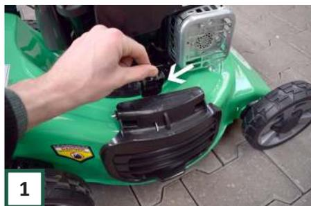
Wenn Sie die Seitenauswurf verwenden möchten, setzen Sie den Mulchstopfen ein und entfernen Sie den Korb. Ziehen Sie den seitlichen clip nach oben.
