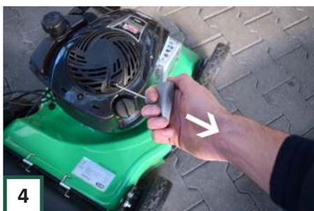
**4** Ziehen Sie nun das Starterseil des Motors mit der rechten Hand in einer sanften Bewegung nach hinten. Der Motor sollte nun innerhalb weniger Hübe starten.
