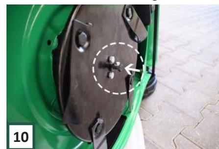
Schrauben Sie dann die Schraube mit der kleinen Unterlegscheibe durch das Messer in die Kupplung. Ziehen Sie es gut an. Das Messer ist jetzt angebracht. Stellen Sie die Maschine aufrecht und installieren Sie das Zündkerzenkabel (siehe Schritt 8 oben). Sie können jetzt mähen.
