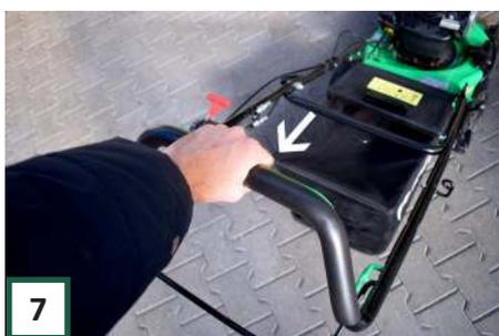
**7** Sie können die Maschine benutzen, indem Sie den vorderen Hebel gedrückt halten und die Maschine drücken.
