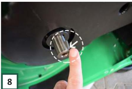
Überprüfen Sie, ob der Halbmondschlüssel richtig in der Welle des Motors sitzt. Stellen Sie sicher, dass es in der Achse leicht abgewinkelt ist. Am Ende leicht absenken, damit die Kupplung des Messers leicht darüber gleiten kann.
