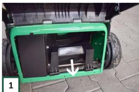
Wenn Sie die Fangkorb verwenden möchten, stellen Sie sicher, dass der Mulchstopfen entfernt ist.
