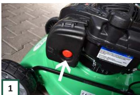
**1** Drücken Sie zuerst dreimal auf den roten Choke-Balg am Motor.
