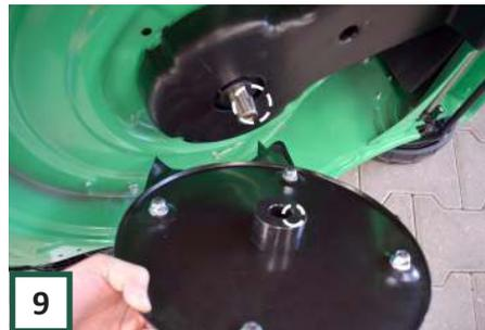
Nehmen Sie nun das Scheibenmesser und schieben Sie die Kupplung vorsichtig über die Welle. Setzen Sie dazu die Aussparung in die Kupplung für den Schlüssel ein. Das Ganze sollte leicht zusammenschieben! Wenn es steif ist, versuchen Sie es erneut. Dies verhindert, dass das Messer schief montiert wird.
