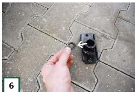
In der T-Kupplung befindet sich eine Unterlegscheibe. Nehmen Sie sie unbedingt heraus.
