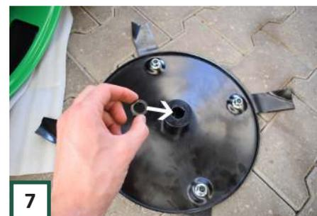
Nehmen Sie nun das Scheibenmesser und setzen Sie den gleichen Distanzring in die Kupplung, die sich bereits auf dem Scheibenmesser befindet. Überprüfen Sie, ob es unten schön und gerade ist!
