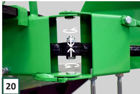
Überprüfen Sie, ob die Scharniere in den Armen richtig eingestellt sind. Ziehen Sie die Schraube und Mutter mit den Schraubenschlüsseln 13 an, bis die Baugruppe gerade nicht mehr scharniert.
