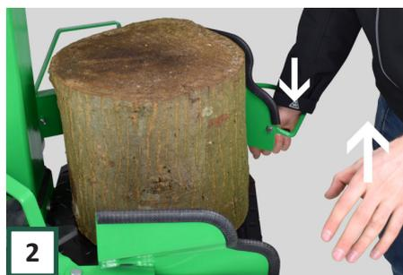
2 Wenn sich das Messer direkt über das Holzblock befindet lassen Sie einer der beiden Hebel los. Das Messer bleibt jetzt auf die entsprechende Höhe stehen.
