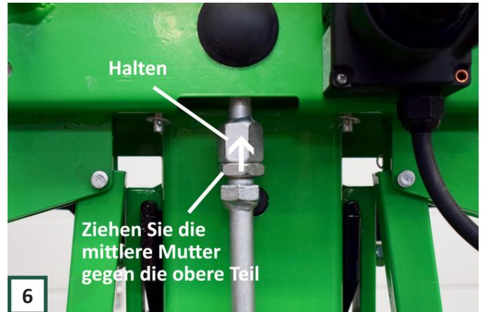
Wenn die Maschine ordnungsgemäß funktioniert, ziehen Sie die Gegenmutter fest am oberen Teil des Mechanismus an. Das Ventil wird wieder richtig eingestellt.
