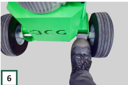
**6** Stellen Sie einen Fuß auf die Fußstütze hinten an der Maschine.
