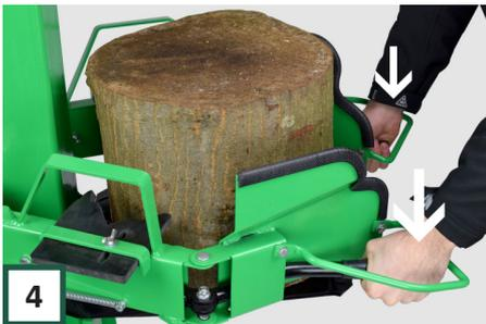
**4** Stellen Sie das zu Spaltendes Holzblock auf den Tisch. Bewegen Sie beide bedienhebel nach innen. Drücken Sie dann beide schwarze Hebel ganz hinein, das Spalt-
