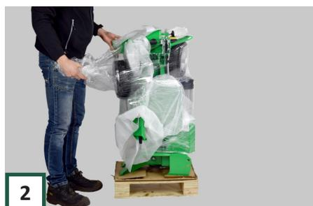
**2** Wickeln Sie den Verpackungsfolie von der Maschine. Stellen Sie sicher, dass die losen Teile nicht fallen.
