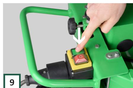
**9** Wenn das Messer die Montage des Tisches verhindert: Schließen Sie die Maschine an und starten Sie. Das Messer hebt automatisch. Schalten Sie es dann wieder aus und stellen Sie den Tisch auf.
