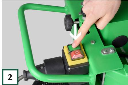
**2** Schalten Sie die Maschine ein durch das Drücken von der grünen Taste. (Siehe Polaritätsumkehr einer 400-V-Maschine auf Seite 12)
