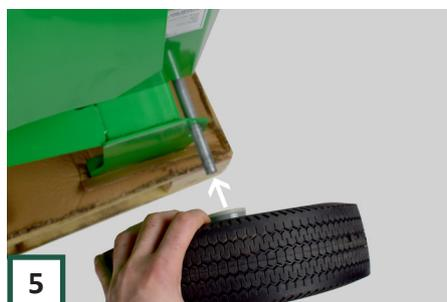
**5** Dann setzen Sie die Räder auf die Achsen. Stellen Sie sicher, dass der hervorstehende Teil des Rads zur Maschine zeigt.
