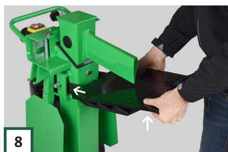
**8** Stellen Sie den Tisch auf, indem Sie ihn schräg in die Halter schieben. Ziehen Sie dann die Schrauben fest an und sichern Sie die Muttern auf beiden Seiten mit dem Schraubenschlüssel 17.
