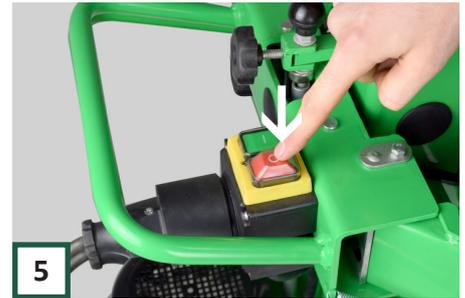
**5** Fahren Sie das Spaltmesser in die untere Position. Schalten Sie die Maschine durch Drücken des roten Druckknopfes aus. Entfernen Sie dann das Verlängerungskabel.
