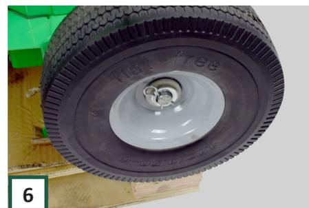
**6** Sichern Sie die Räder, indem Sie die beiden großen Ringe und die Sicherungsfedern auf beiden Seiten der Achse montieren
