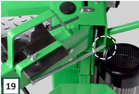
Haken Sie die Feder in den Rahmen der Maschine ein. Die Betätigungsarme werden somit automatisch zur Seite gezogen.
