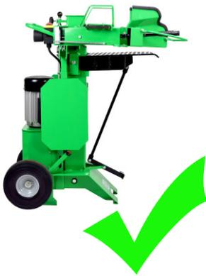
Beim Lagern immer das Messer vollständig einfahren. (Siehe Abbildung links) Dadurch wird sichergestellt, dass sich die Kolbenstange im Zylinder im Öl befindet, Das verlängert die Lebensdauer der Maschine. Verwenden Sie das Gummiband, um die Arme während des Transports und Lagerung zusammenzuhalten. Lagern Sie die Maschine auf einer stabilen Oberfläche. Und auf einem Trockenem Platz.
