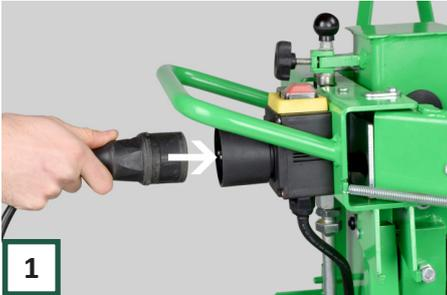
**1** Schließen Sie die Maschine an ein dickes Verlängerungskabel an. Mindestens 2,5 mm<sup>2</sup> bei 230 Volt. Oder 5-poliges Kabel 16A bei 400 V.
