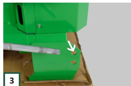
**3** Lassen Sie die Maschine auf der Palette und schieben Sie die Achse für die Räder durch das obere Loch auf beiden Seiten der Fuss.
