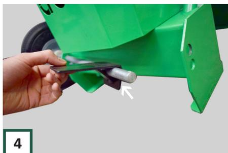
**4** ACHTUNG! Stellen Sie sicher, dass die Fußstütze hinter der Maschine platziert ist, indem Sie die Achse wie auf dem Foto oben gezeigt einsetzen.
