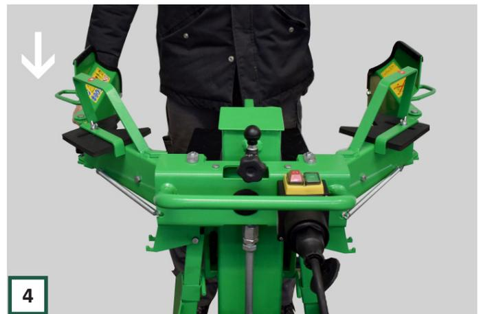
Prüfen Sie, ob die Säule beim Drücken des rechten Hebels herunterfällt. Passen Sie den Mechanismus an, bis dies der Fall ist.
