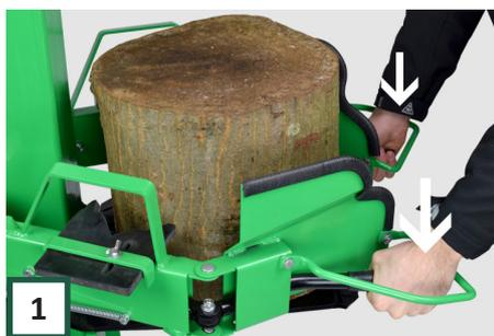
1 Legen Sie ein grobes Stück Holz als Maßstab und senken Sie die Säule mit dem Messer ab, indem Sie beide Hebel drücken.
