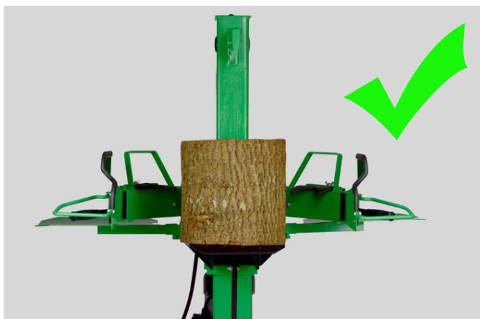
Bevor Sie mit dem Spalten anfangen. Stellen Sie das Holz immer senkrecht auf die Maschine und stellen Sie sicher, dass das Holz hinten an die Säule anliegt, bevor Sie mit dem Spalten beginnen
