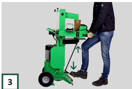
3 Drücken Sie dann das Fußpedal mit Ihrem Fuß herunter. Der Tisch geht dadurch hoch und drückt das Holz im Messer. Halten Sie den Fuss auf das Pedal und drücken Sie mit beide Hände die Hebel nach unten. Das Holz wird gespalten.
