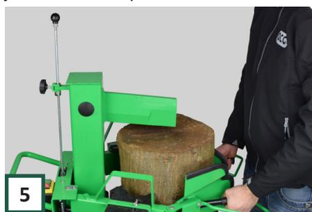
5 Die Hublänge ist jetzt eingestellt. Setzen Sie nach der Arbeit die Hublänge zurück in Originalhöhe und lagern Sie die Maschine immer mit dem Spaltmesser in der niedrigsten Position. (Siehe S. 16).
