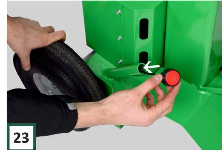
Entfernen Sie dann den Stopfen am Einfüllstutzen des Öltanks und setzen Sie den Ölmesstab dort ein.
