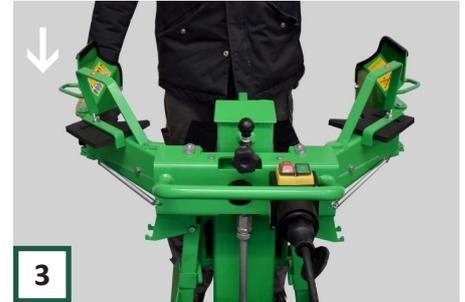
**3** ACHTUNG! Starten Sie die Maschine bei kaltem Wetter mit 1 gedrücktem Hebel. Erwärmen Sie es 1 Minute lang, bevor Sie den Hebel loslassen und die Säule anheben.
