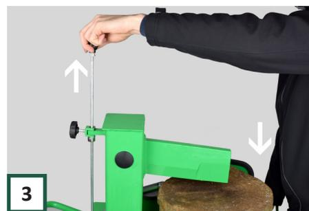
3 Halten Sie noch immer mit einen Hand den Hebel gedrückt und ziehen Sie mit die andere Hand den Stift für die Höhenverstellung nach oben.
