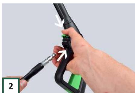
2 Drehen Sie den Hochdruckschlauch von der Rolle und verbinden Sie ihn mit der Sprühlanze über die Bajonettkupplung. Drücken Sie die Taste platzierte den Stecker. Überprüfen Sie, ob es steckt.
