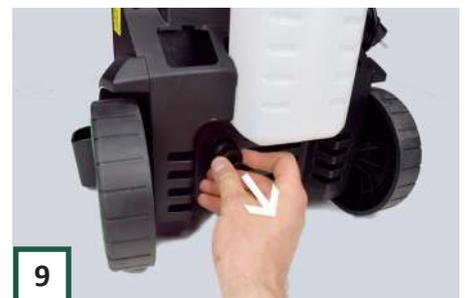
**9** Entfernen Sie dann die Schutzkappe am Schraubkupplung des Hochdruckschlauchs hinten.
