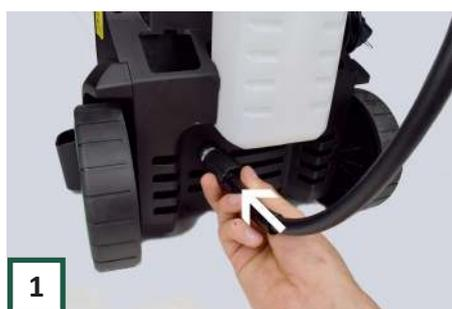
1 Stellen Sie die Maschine auf ebenen Boden und schließen Sie den Hochdruckschlauch über die Schraubkupplung an die Maschine an. (Sie können es nach Gebrauch auch montiert lassen.)
