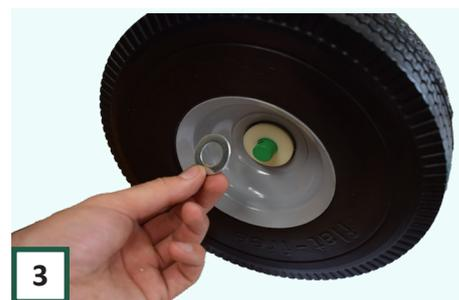
**3** Setzen Sie den Sicherungsring gegen das Rad.
