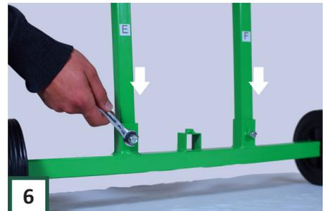
**6** Schieben Sie dann die Teile "E&F" in Teil "G". Verwenden Sie zwei M8-Schrauben, um sie zu befestigen.
