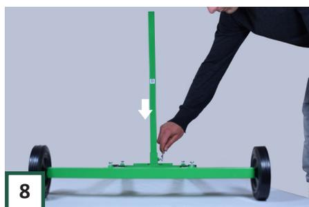
**8** Danach legen Sie die Baugruppe waagrecht, schieben Teil "B" in Teil "D" und ziehen es mit einer M8-Schraube fest.
