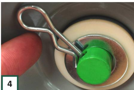
**4** Setzen Sie die Sicherungsfeder ein, um die Räder in Position zu halten.
