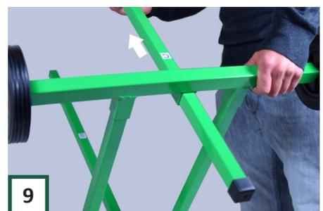
**9** Heben Sie nun die Baugruppe an den Rädern an und schieben Sie Teil "C" von unten durch den Radkasten (Teil "G").
