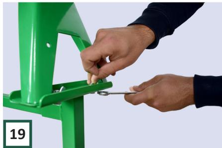
Verbinden Sie den vorderen Fuß des Kleeblattes mit dem Ständer mit zwei M8-Schrauben, 4 Unterlegscheiben und zwei Flügelmuttern.
