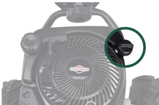
Entfernen Sie den Messstab und stellen Sie sicher, dass der Dichtring des Messstabs an Ort und Stelle bleibt. Dann 0,6 Liter Öl hinzufügen (genau auf der obersten Ebene), nicht weniger, aber auch nicht mehr hinzufügen! SAE 30 oder gleichwertiges Motoröl verwenden.
