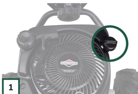
Stellen Sie sicher, dass die Maschine waagrecht zum Stillstand gekommen ist. Öffnen Sie dann die Kappe mit dem Messstab. (Gießen Sie 0,6 Liter Öl in den Behälter, bevor ersten Mal verwenden)
