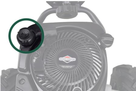
Schrauben Sie den Deckel des Kraftstofftanks ab und füllen Sie den Tank mit Benzin. Schließen Sie dann die Kappe wieder.
