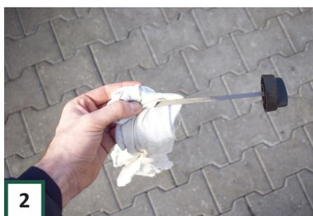
Trocknen Sie den Messstab anschließend mit einem Tuch oder einem Stück Papier ab.
