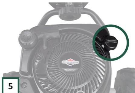
Sobald das Öl auf den richtigen Stand gebracht wurde, können Sie den Ölmessstab ersetzen und festziehen.
