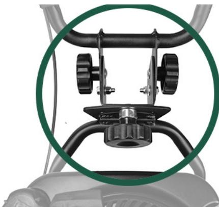
Sie können die Position der Lenkhalterung sowohl in X- als auch in Y-Richtung anpassen. Mit den beiden Einstellknöpfen an der Seite können Sie den Lenker vertikal in der Höhe verstellen, auf die für Sie als Benutzer richtige Höhe. Mit der unteren Taste können Sie den Lenker horizontal verstellen, um beispielsweise problemlos an Wänden oder Zäunen entlang zu gehen. Achten Sie darauf, die Knöpfe zum Einstellen zu lösen und vor Arbeitsbeginn wieder festzuziehen.
