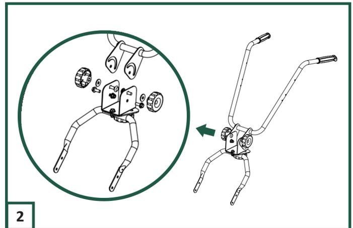
2 Verbinden Sie dann den unteren Teil mit dem oberen Teil der Lenkerhalterung. Zuerst zwei Schrauben und Muttern mit Schlüssel 15 durch die beiden Scharnierlöcher stecken. Dann die beiden Schlossschrauben von innen durch die halbrunden Langlöcher stecken, die großen Unterlegscheiben von außen aufschieben und die großen schwarzen Knöpfe festziehen.
