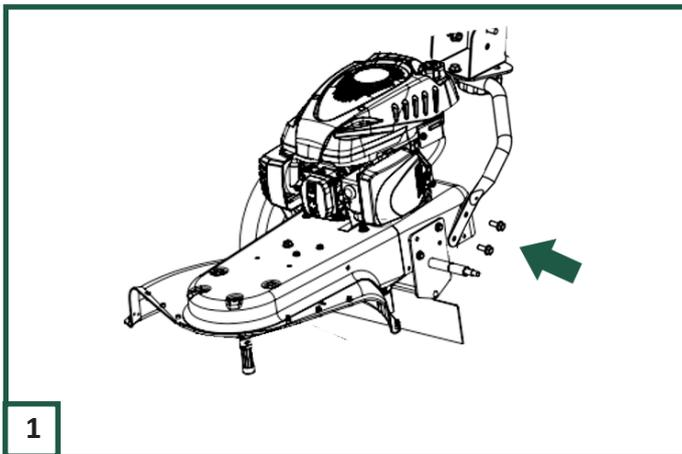
1 Platzieren Sie den unteren Teil der Lenkerhalterung hinten der Maschine und ziehen Sie sie mit den M8-Schrauben auf beiden Seiten der Maschine mit Schlüssel 13 fest. (TIPP: Eine detaillierte Zeichnung finden Sie auf Seite 26.)
