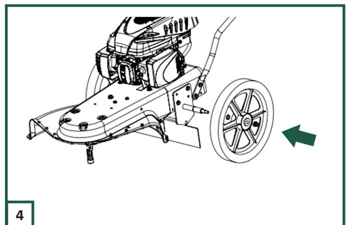
4 Schieben Sie dann die Räder auf beiden Seiten über die Achsen und ziehen Sie sie mit den Federscheiben und selbstsichernden Muttern mit einem Schraubenschlüssel der Größe 15 fest.
