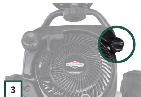
**3** Setzen Sie dann den Messstab wieder in den Ölbehälter ein. Schrauben Sie dann die Kappe wieder ab und entfernen Sie sie vollständig aus dem Reservoir.
