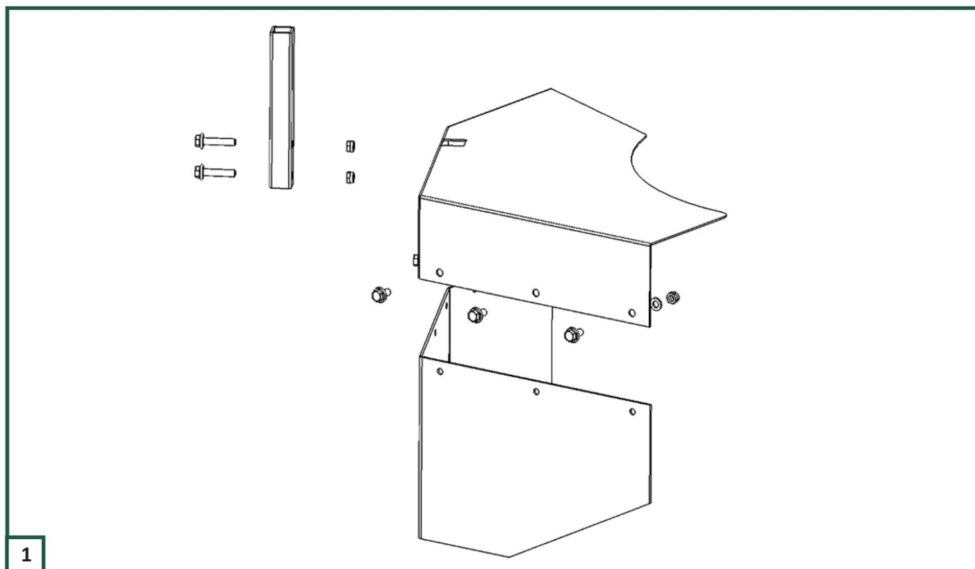
Beginnen Sie damit, die Metallverbindungsmuffe durch die Aussparung in der Metalloberseite zu stecken. Schieben Sie dann die beiden langen M8-Schrauben von außen durch die Metalloberseite und die Muffe. Schrauben Sie dann die Muttern auf die Bolzen auf der Innenseite und ziehen Sie sie mit dem Schraubenschlüssel 13 fest.
