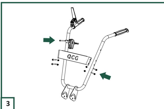
3 Platzieren Sie die grüne Verbindungsplatte über dem oberen Teil der Lenkerhalterung. Schiebe die 4 langen M6-Schrauben von außen durch die Platte und Rohre und befestigen mit den 4 Muttern mit einem Schlüssel 10. Montiere die Gashebel mit der langen Schraube und Mutter auf den rechten Griff (vom Betrieb aus gesehen). Von innen mit der Kappe abdecken.
