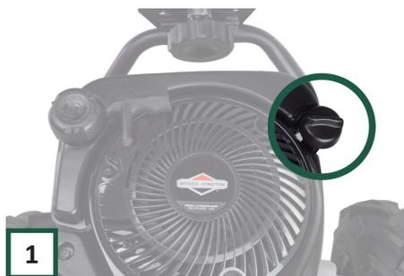
**1** Stellen Sie sicher, dass die Maschine waagrecht zum Stillstand gekommen ist. Öffnen Sie dann die Kappe mit dem Messstab. (Gießen Sie 0,6 Liter Öl in den Behälter, bevor ersten Mal verwenden)
