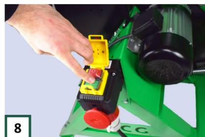
**8** Schalten Sie die Maschine ein, indem Sie den grünen Druckknopf am Schalter drücken. (Siehe Phase Verwendung einer 400-V-Maschine bei verkehrtem Motor auf Seite 11) Lassen Sie die Maschine Höchstgeschwindigkeit erreichen, bevor Sie mit dem Schneiden beginnen. Schalten Sie die Maschine nach dem Gebrauch durch Drücken des roten Knopfes aus.
