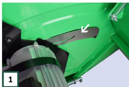
1 Schmieren Sie die beweglichen Teile nach jedem Gebrauch gut mit Fett ein. Schmieren Sie die Führungsplatte vollständig ein. Verwenden Sie vorzugsweise ein Mehrzweckfett ohne Säuren.
