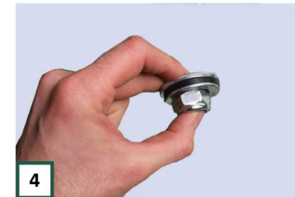
4 Entfernen Sie die Mutter und die dahinter liegenden Unterlegscheiben. Achten Sie darauf, dass Sie sie später wieder in der richtigen Reihenfolge montieren und nicht verlieren.
