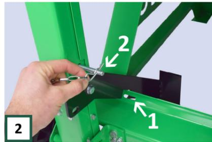
2 Drücken Sie dann den Griff des Schutzes ein und schieben Sie den Stammhalter ein und schieben Sie den Stammhalter ein. Der Wippenbegrenzer hakt nun automatisch in den Rahmen ein. Sichern Sie anschließend den Wippenbegrenzer mit dem Stift und der Sicherungsfeder.
