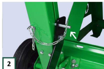
**2** Sichern Sie den Wippbegrenzer mit dem Stift, indem Sie ihn durch den Sockel und den Wippbegrenzer schieben, und sichern Sie den Stift dann mit der Sicherungsfeder.
