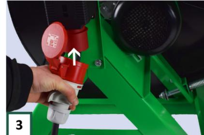
**3** Schließen Sie das Gerät mit einem dicken Verlängerungskabel (2,5 mm<sup>2</sup>) an eine 230V-Quelle an. (5-poliges Kabel 16A im Falle von 400v).
