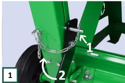
1 Entriegeln Sie den Wippenbegrenzer, indem Sie die Sicherungsfeder und den Sicherungsstift entfernen, und klappen Sie dann den Wippenbegrenzer nach innen.
