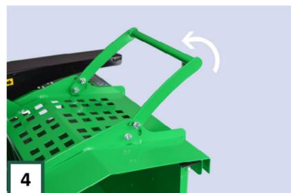
**4** Stellen Sie den Griff der Schutzklappe auf eine für Sie angenehme Höhe ein. Verwenden Sie dazu 2x Schlüssel 13.
