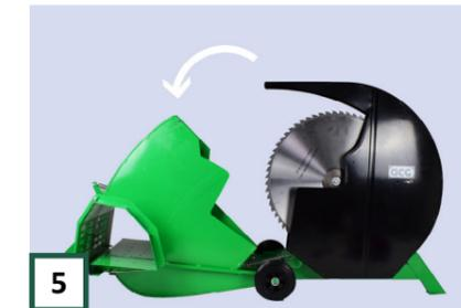
5 Jetzt den Wippenbegrenzer wieder entriegeln und nach außen klappen, aber nicht mit dem Sicherungsstift verriegeln! (Schritt 1 der Bedienung auf Seite 12). Senken Sie nun den Holzhalter ganz nach außen ab, bis er auf dem Boden aufliegt.
