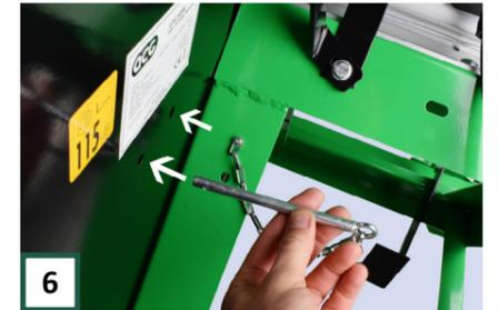
6 Setzen Sie dann den Arretierstift zur Verriegelung des Sägeblatts ein. Das innere Loch ist für die 600-mm-Säge und das äußere Loch für die 700-mm-Säge.
