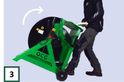
3 Sie können die Maschine nun kippen, indem Sie einen Fuß auf den Rahmen stellen und den Griff an der Schutzabdeckung zu sich heranziehen. Stellen Sie die Maschine bei der Lagerung fest auf ihre 4 Füße und schützen Sie sie vor Feuchtigkeit.
