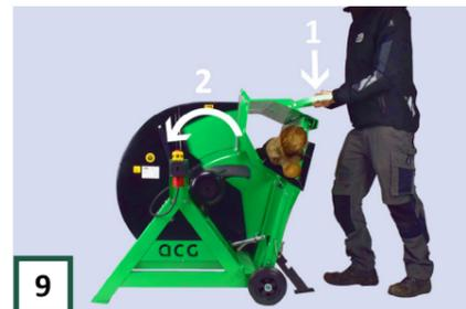
**9** Schließen Sie nach dem Einlegen des Holzes die Klappe und drücken Sie mit beiden Händen den Griff der Klappe nach unten, bis er den Schutz freigibt. Schieben Sie dann den Holzhalter vorsichtig in Richtung Sägeblatt, bis das Holz vollständig durchgeschnitten ist. Lassen Sie den Holzhalter zurückfedern, öffnen Sie die Klappe und schieben Sie das Holz durch, dann wiederholen Sie den Vorgang.
