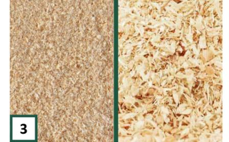
3 Schließlich ist Sägemehl eine gute Maßnahme. Das Sägemehl einer scharfen Säge ist in Ordnung. Sobald größere Späne und Locken auftreten, ist das ein Zeichen für ein stumpfes Sägeblatt.
