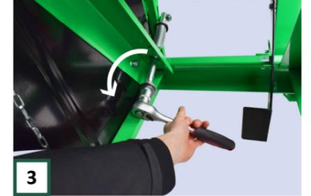
3 Prüfen Sie, ob die Kipphebelfeder richtig arretiert ist. Dann die Mutter mit einem Schraubenschlüssel 24 von der Kipphebelfeder abschrauben.
