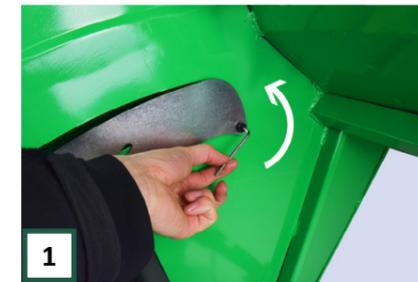
1 Schrauben Sie die Inbusschraube der Polierplatte mit einem Inbusschlüssel 4 mm ab.
