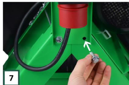
**7** Ziehen Sie dann den Schalter mit zwei M8-Schrauben, Unterlegscheiben und Muttern fest.
