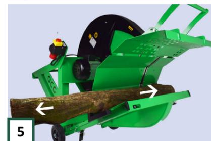
**5** Öffnen Sie die Klappe mit dem Griff und legen Sie das Holz ein. Tun Sie dies immer mit der Maserung senkrecht zum Sägeblatt. (siehe Bild oben)
