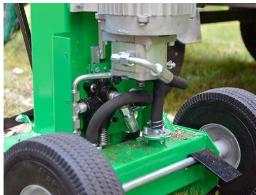
Gut geschützt: Die Hydraulik ist hinter der Spaltsäule unter einer Abdeckung montiert.
