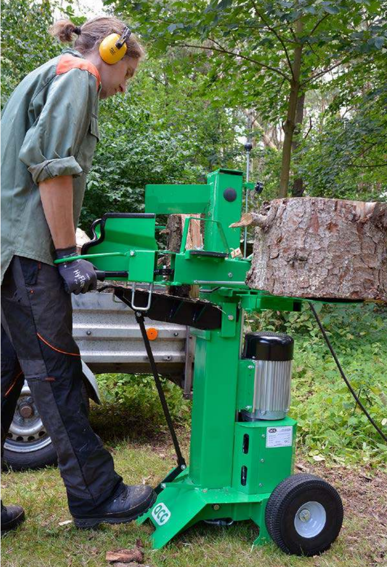
Der Kurzholzspalter ist mit einem Fußpedal zum Anheben des Spalttisches ausgestattet. Für mehr Sicherheit und eine bessere Handlung wird das Holz so weg vom Bediener fest unter den Keil gedrückt.
