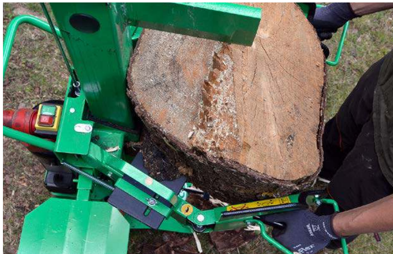
Die langen, patentierten Knickarme der Zweihandbedienung „umarmen“ das Holz beim Spalten. Durchmesser bis etwa 80 Zentimeter konnte HOLZmachen damit im Test verarbeiten.
