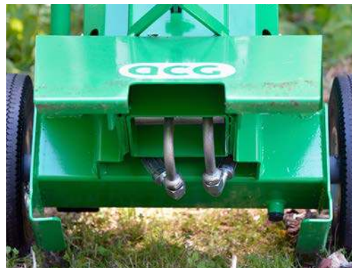
Zu nah am Boden: Zwei Hydraulikleitungen verlaufen ungeschützt direkt unter der Bodenplatte.
