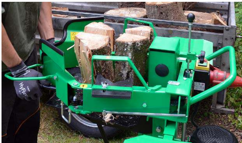
Durch die langen Knickarme fallen fertige Scheite nicht vom Tisch.
