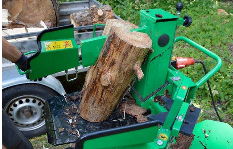
Der anhebbare Spalttisch erleichtert alle Arbeiten, besonders das Spalten von krummgesägten Abschnitten. Fotos: Riemann
