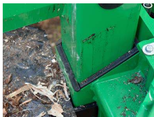
Der Gleitraum der Säule ist mit Gummi abgedichtet. Laut dem Hersteller gibt es damit seit Jahren keine Probleme.
