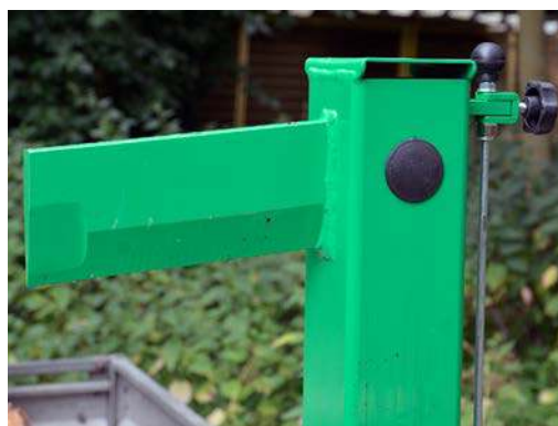
Das Spaltmesser mit drei Schnittzonen, hinter der Spaltsäule die magnetische Hubbegrenzung.
